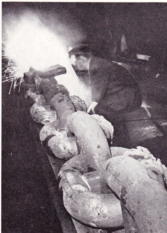
Het afbramen van een gelaste ketting door middel van elektrisch gutsen
